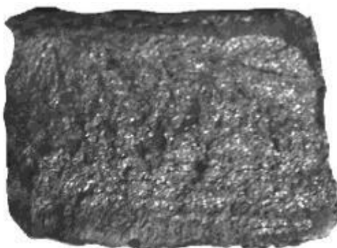
Рисунок Б.12 - Излом среднезернистый, кристаллический
