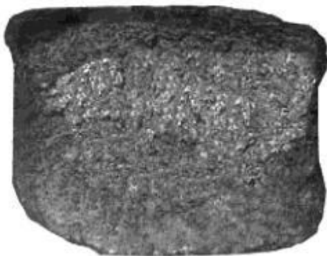
Рисунок Б.5 - Излом мелкозернистый, матовый, с участками металлического блеска
