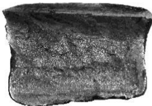
Рисунок Б.8 - Излом мелкозернистый, кристаллический
