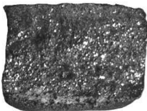
Рисунок Б.13 - Излом среднезернистый, кристаллический
