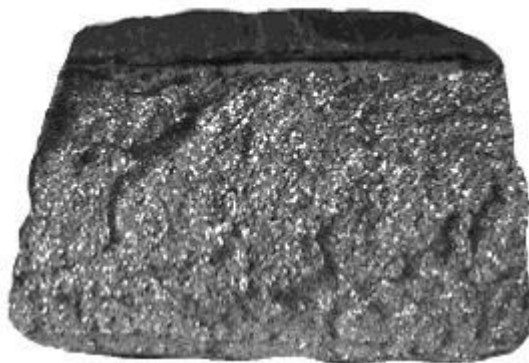
Рисунок Б.11 - Излом мелкозернистый, кристаллический
