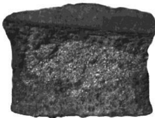
Рисунок Б.6 - Излом мелкозернистый, матовый, с участками металлического блеска
